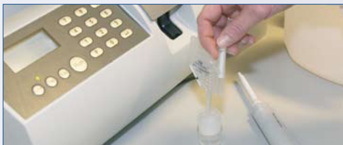
Sædens tæthed måles på et meget nøjagtigt instrument, Nucleo-counter SP100. Sædcernes DNA-kerne indfarves, og derved kan kernerne tælles ved hjælp af fluorescens mikroskopi.
